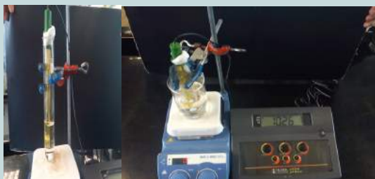
Figura 5.1.- Montaje experimental de la reacción de hidrólisis de acetato de etilo
