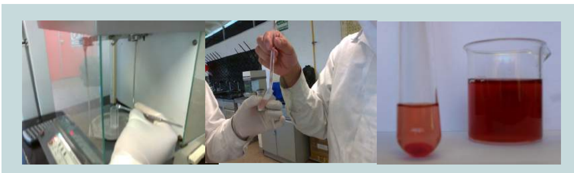
Figura 9.1 Experimento de adsorción de jugo de arándano. En el vaso de precipitados se presenta el jugo de arándano diluido al 50%. En el tubo de ensaye se observa en el fondo la bentonita que ha adsorbido parte del color presente en el jugo.
