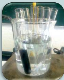
Figura 2.2 Color azul observado en la actividad experimental de cinética de la “reacción reloj” de persulfato con yoduro
