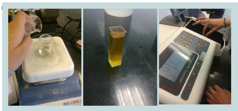
Figura 4.1. Montaje experimental de la reacción entre los iones férrico y yoduro
