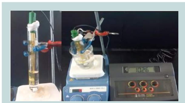
Figura 1.2.- Montaje experimental de la reacción de hidrólisis de acetato de etilo
