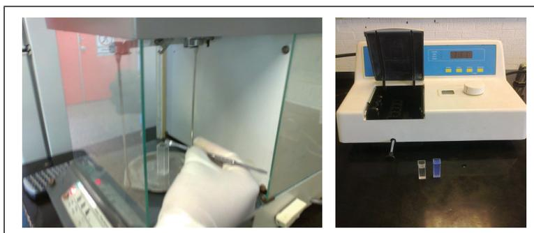
Figura 8.1 Montaje experimental de la cinética de adsorción
