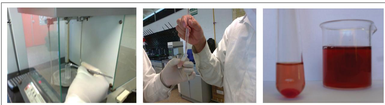
Figura 9.1 Experimento de adsorción de jugo de arándano. En el vaso de precipitados se presenta el jugo de arándano diluido al 50%. En el tubo de ensaye se observa en el fondo la bentonita que ha adsorbido parte del color presente en el jugo
