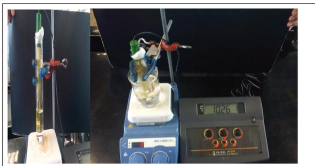
Figura 5.1 Montaje experimental de la reacción de hidrólisis de acetato de etilo
