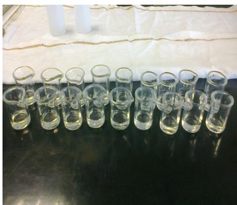
3. Vierta rápidamente el contenido del sistema IB en el sistema IA, accionando inmediatamente el cronómetro, agite con agitador magnético durante 5 s, vaciar rápidamente en una celda de espectrofotómetro y tomar lectura cada 10 s durante 120 segundos (Sistema I).
