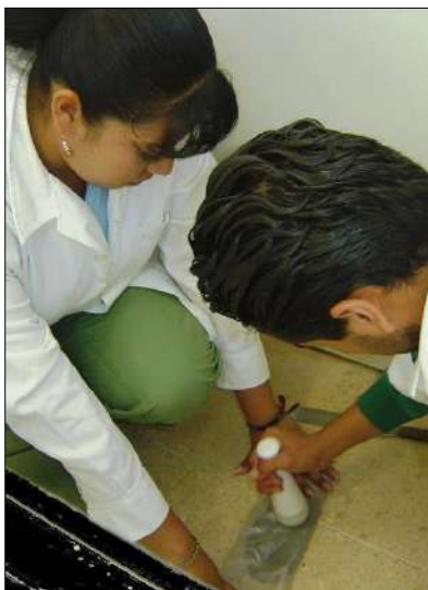
Figura 11. Ligera disgregación manual de las muestras
