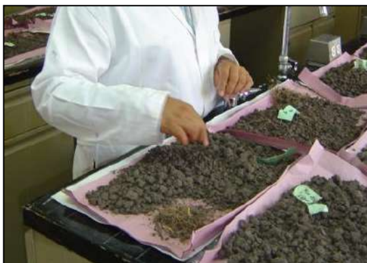
Figura 3. Separación manual de raíces y fragmentos gruesos
