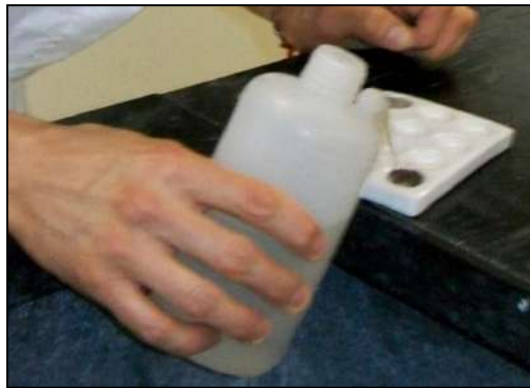
Figura 28. Humedecer una de las dos muestras.
