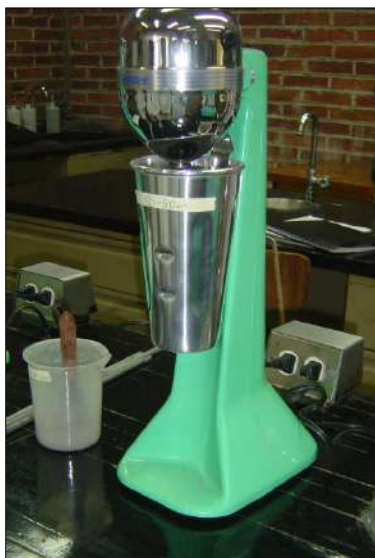
Figura 12. Agitación de la muestra
