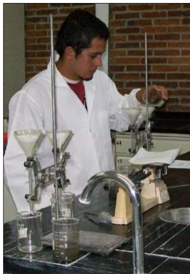
Figura 38. Filtrado de las muestras
