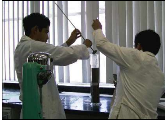
Figura 15. Introducción del hidrómetro después de la agitación por un minuto
