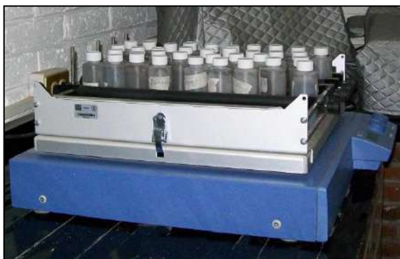
Figura 35. Agitación de las muestras
