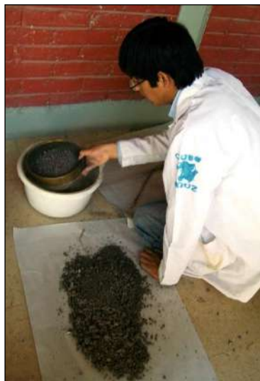
Figura 6. Tamizado de muestras
