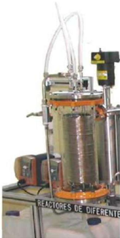
**Figura 1. Reactor tubular instalado en el LEM**
