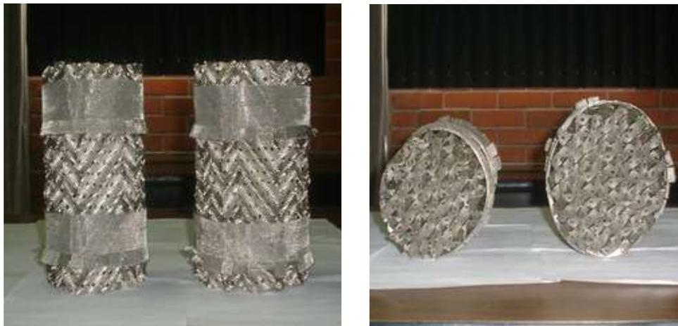
**Figura 2. Empaques de tipo estructurado instalados en la torre de destilación de la nave 1000 de Ingeniería Química**
