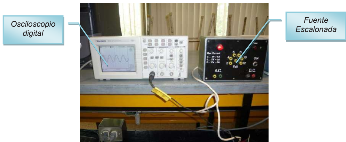
Figura 6.9 Medición de onda de C.A.
