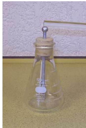
Figura 2.9 Electroscopio de láminas, carga por contacto
