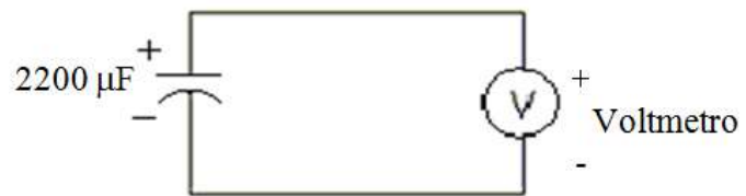
Figura 3.7 Medición del voltaje almacenado en un capacitor
