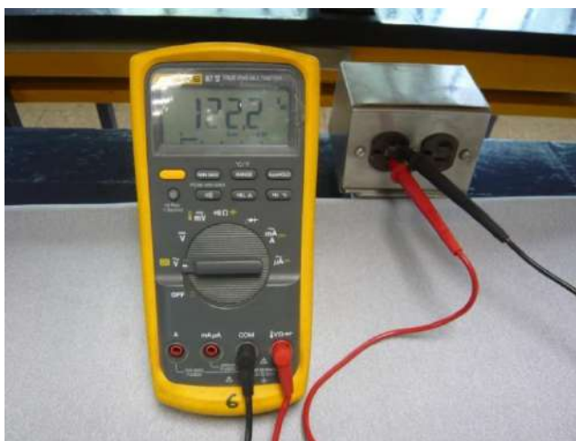
Figura 1.12 Medición de voltaje alterno
