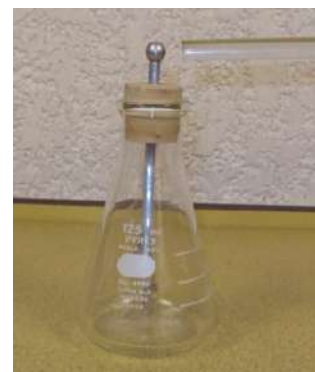
Figura 2.10 Electroscopio de láminas, carga por inducción
