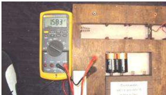
Figura 6.13 Conexión de pilas en en paralelo de pilas
