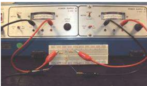
Figura 5.12 Circuito resistivo serie-paralelo, con dos FEMs
