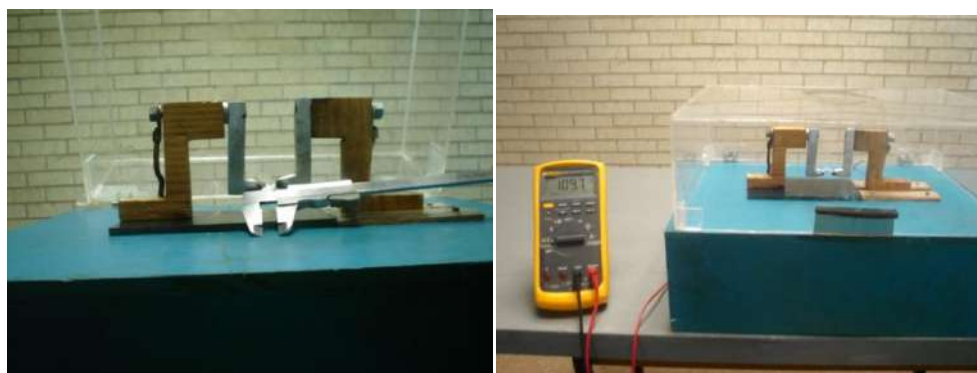
Figura 3.15 Ruptura de rigidez dieléctrica del aire
