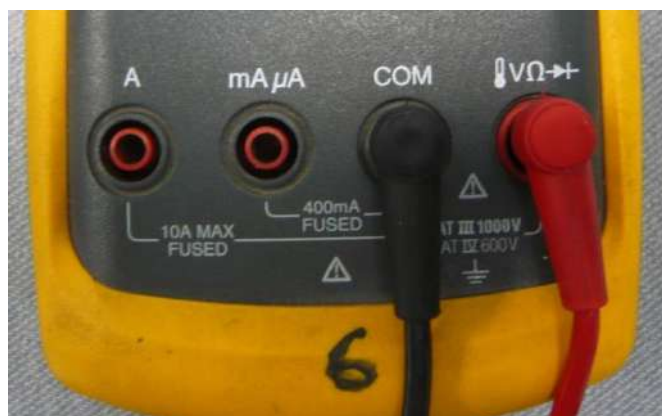
Figura 1.8 Conexión de puntas de multímetro digital para medición de voltaje y resistencia
