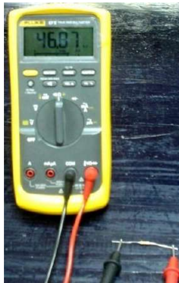
Figura 4.3 Medición de resistencia con multímetro
