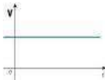
Figura 1.2 Señal de voltaje continuo
