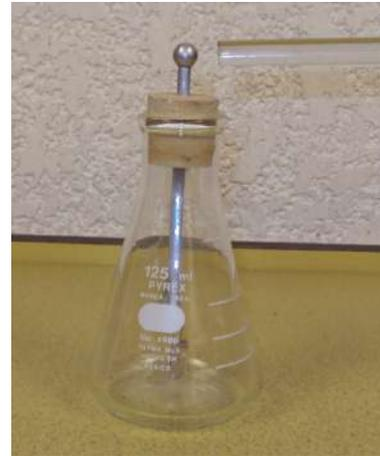
Figura 1.1b Electroscopio de láminas, carga por inducción
