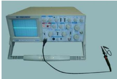
Figura 7.1 Osciloscopio analógico
