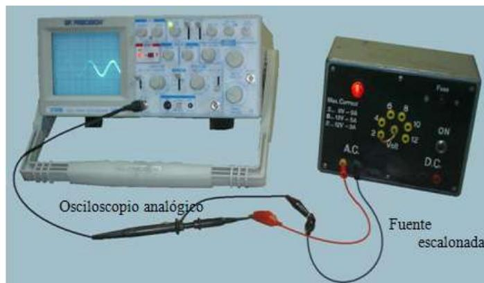
Figura 7.3 Medición de onda de C.A.
