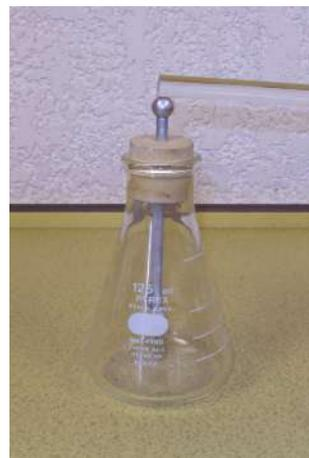
**Figura 1.1a Electroscopio de láminas, carga por contacto**
