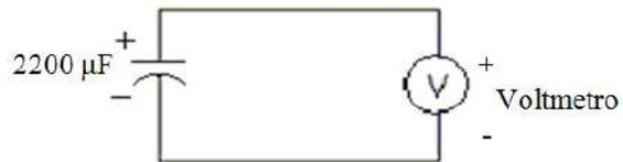
Figura 2.5 Desenergización de un capacitor
