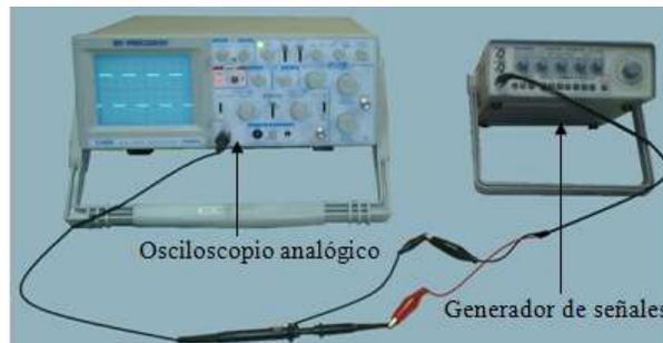
Figura 7.2 Conexión del generador de señales al osciloscopio
