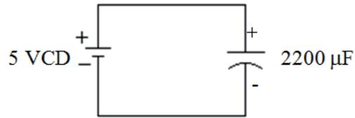
Figura 2.4 Energización de un capacitor
