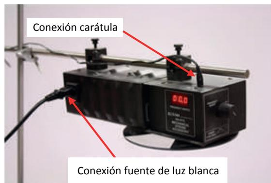
Figura 1.11. Estroboscopio mecánico
