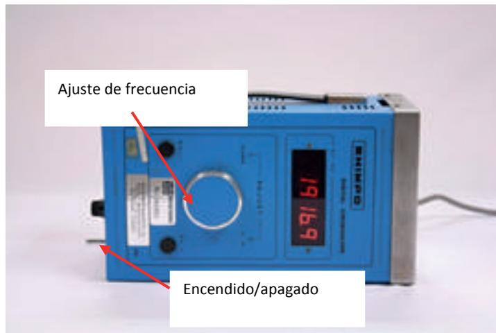
Figura 1.10. Estroboscopio
