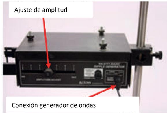
Figura 1.12. Generador de ondas
