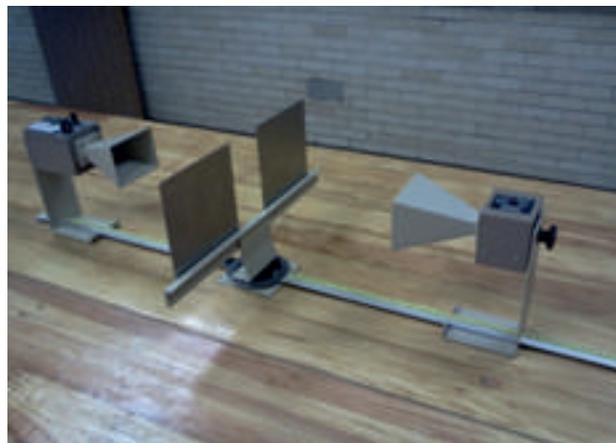
Figura 7.5. Difracción de rendija simple con el equipo de microondas
