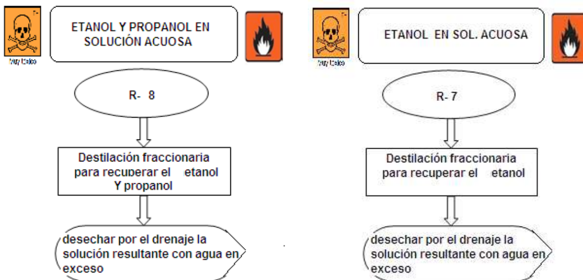
Figura 2. Diagrama ecológico para el manejo de residuos
