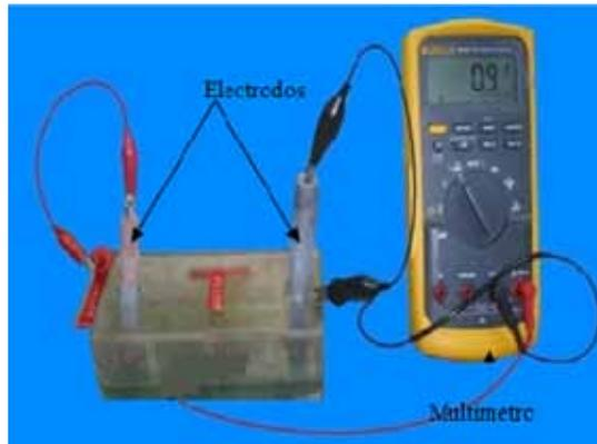
Figura 6.2 Diferencia de potencial entre electrodos
