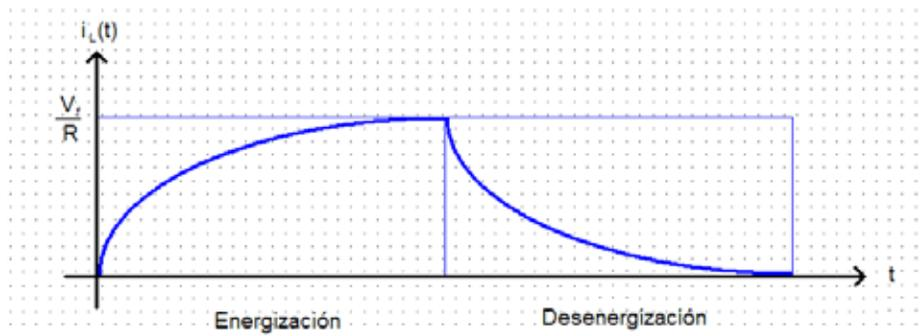
Figura 9.5 Energización y desenergización del circuito RL
