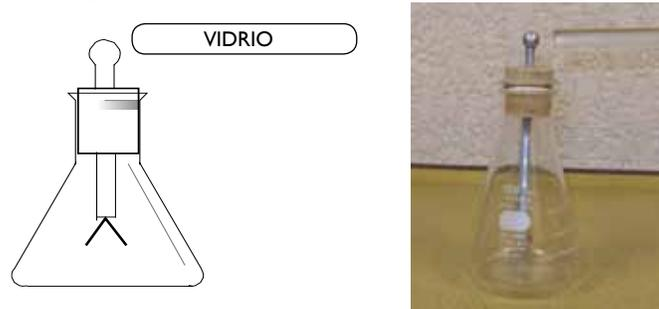
Figura 1.11b Electroscopio de láminas, carga por inducción
