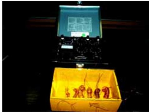
Figura 4.8 Medición de la resistencia óhmica de conductores de diferentes calibres
