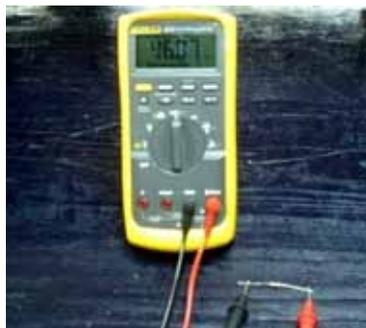
Figura 4.4 Medición de resistencia con multímetro
