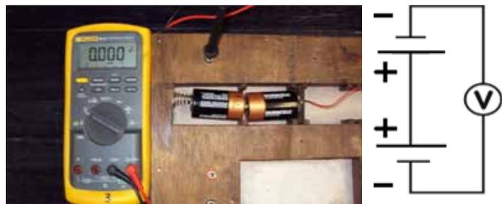
Figura 6.6b Conexión serie sustractiva
