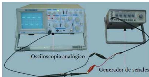
Figura 5.6 Conexión del generador de señales al osciloscopio
