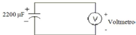
Figura 2.10 Desenergización de un capacitor
