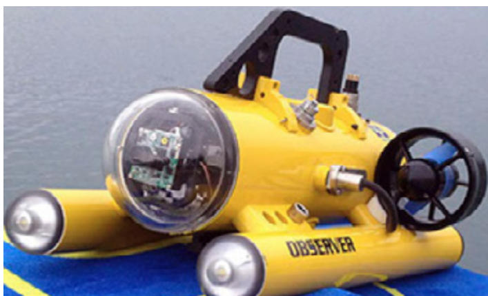
Figura 2. El Observer Mini-Rov, es un robot submarino de inspección. (Nils Int'l Ltd, 2023)
