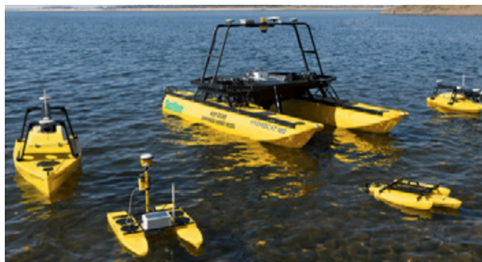
Figura 3. Vehículos Seafloor Systems, especializados en levantamientos hidrográficos. (Unmanned Systems Technology, 2022).
