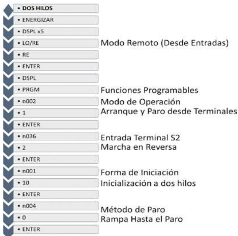
Figura 40 Lista de comando para monitorear la frecuencia
