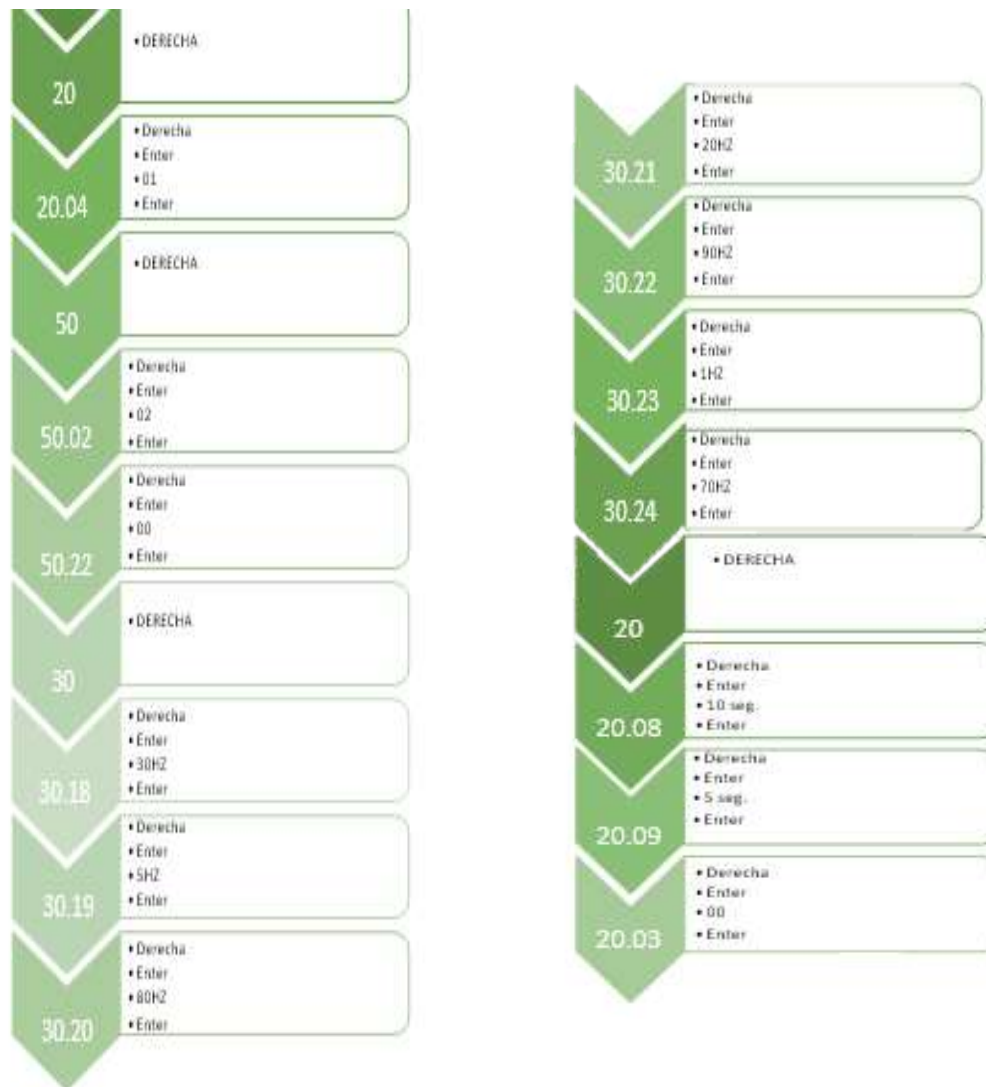
Figura 54 Diagrama de bloques para múltiples velocidades con el variador de frecuencia Eaton MVX9000
