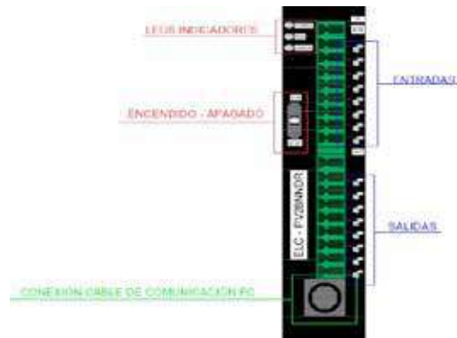
Figura 55 Controlador lógico ELC Eaton
