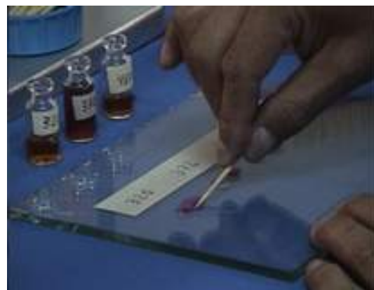
Figura 74. Se depositan 0.03 ml de antígeno sobre la placa o tarjeta. Se mezclan con un palillo en forma circular.
