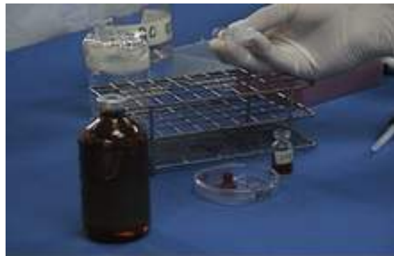
Figura 59. Se agita suavemente la muestra y se deja incubar por una hora a temperatura ambiente de 20 °C.
