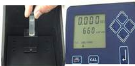
Figura 60. Calibración del espectrofotómetro. Se calibra el espectrofotómetro a 0, utilizando un tubo control con el reactivo de sulfato de zinc. A continuación se mezcla bien el contenido del tubo prueba y se realiza la lectura.
