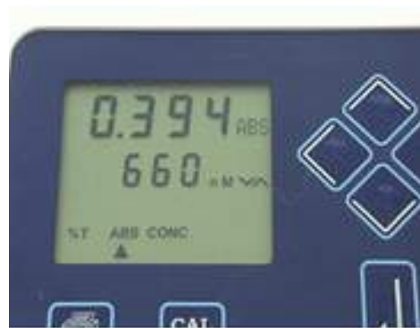
Figura 61. Lectura. Se lee el grado de absorbancia (turbidez) a una longitud de onda de 660 nm en el espectrofotómetro.
