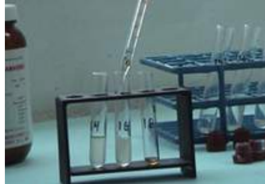
Figura 50. Al primer tubo se le añade 1.9 ml de solución de sulfito de sodio al 14%, utilizando una de las pipetas de 5 ml de capacidad. Con el segundo y tercer tubo se hace lo mismo, añadiéndoles las soluciones al 16% y al 18% y utilizando dos pipetas diferentes.
