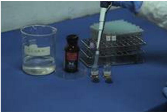
Figura 79. Con una pipeta colocar 0.4 ml de la solución de suero en cada tubo.
