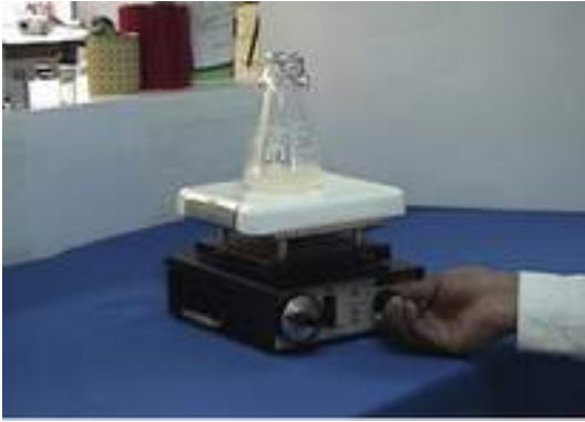
Figura 100. El agar se disuelve por calentamiento hasta su clarificación (100°C).
